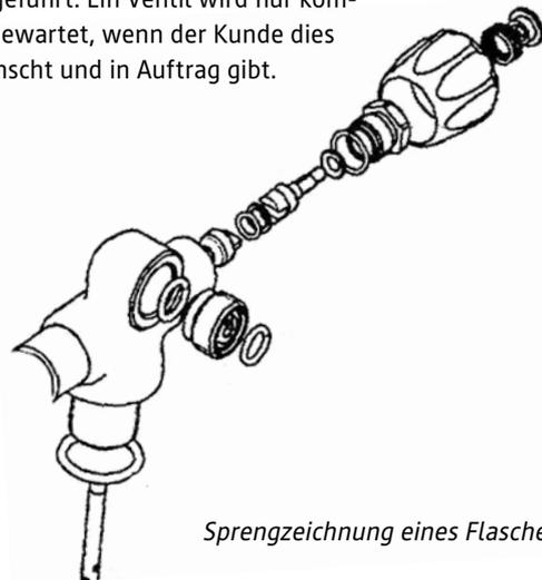
*Sprengzeichnung eines Flaschenventils*
