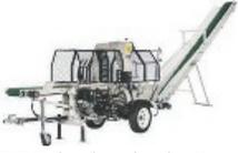
PRO hydraulisch, Benzinmotor 420 cm<sup>3</sup>, 9,2 kW. Spaltlänge max. 50 cm. Spaltdurchmesser max. 10 bis 50 cm inkl. Abförderband. Preis Fr. 8500.- statt Fr. 10550.-. Lieferung möglich. [www.kebumaschinen.ch](http://www.kebumaschinen.ch)
