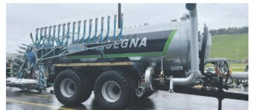
Kapazität 11500 lt. Vakuum-Pumpe 13500 l/min., lenkbare Achse mit Rückfahrsperrung, Anhängung K80, Saugarm Fahrtrichtung rechts, Turbofüller, Bereifung 710 / 50 R26.5 BKT, Bomech Schleppschuhverteiler Speedy One 10.50 m mit Elektro Hydr. Steuerung, Füllstandsanzeige. Zulassung 40 km / h. VP: Fr. 98000.-.
